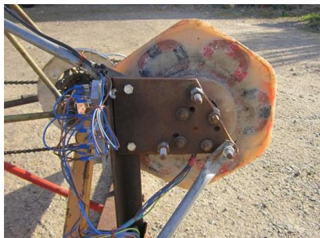
La génératrice 12V est construite sur la base des plans d'Hugh Piggott, tels que détaillés dans le manuel Tripalium.
