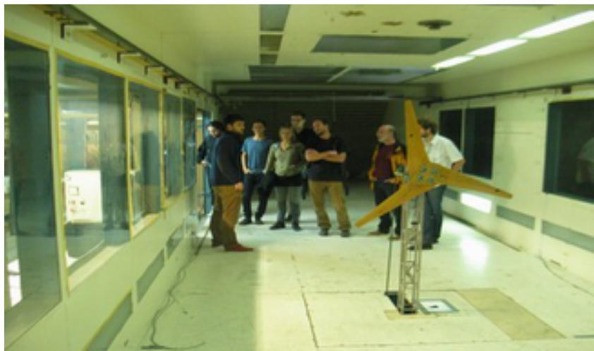
Une éolienne de 1,2 m de diamètre est placée dans une soufflerie. Des séries de mesures pour des vitesses de vent variables permettent de collecter des informations sur les caractéristiques de l'éolienne : le coefficient de performance, le TSR, la courbe de
