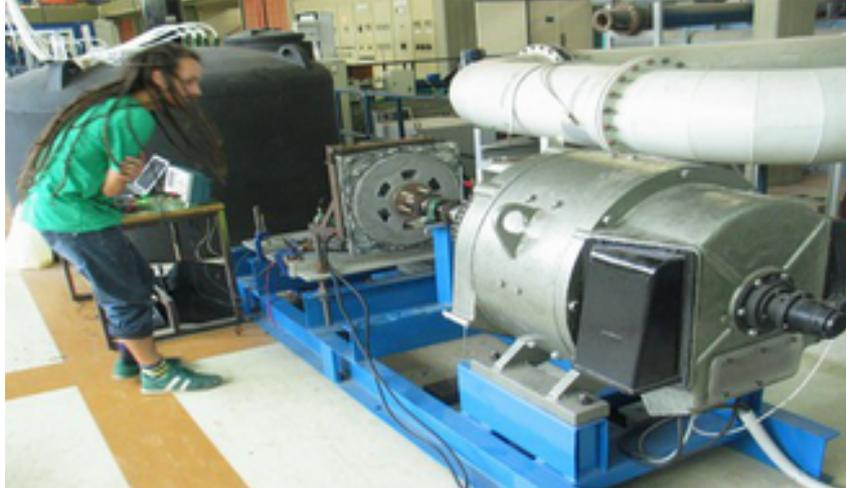
Cette session présente un système de mesure sur un banc d'essai. Le banc d'essai est constitué d'un moteur entraînant une génératrice sur laquelle nombres de paramètres sont mesurés. Le dispositif expérimental mentionné permet une analyse complète du comportement du générateur dans différentes situations.
