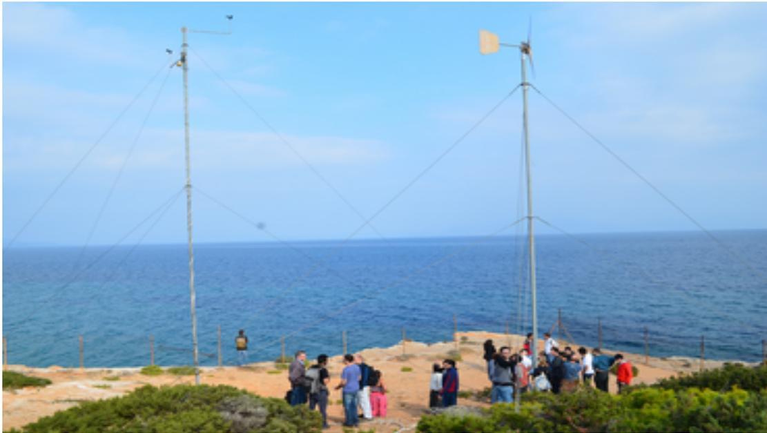
L'infrastructure du site d'essai permet l'installation et l'essai de petites éoliennes allant de 1,2 m à 7,6 m de diamètre soit hors réseau (charge de batterie) soit raccordées au réseau. Le site répond aux exigences des normes internationales concernant les tests de petite éolienne.
