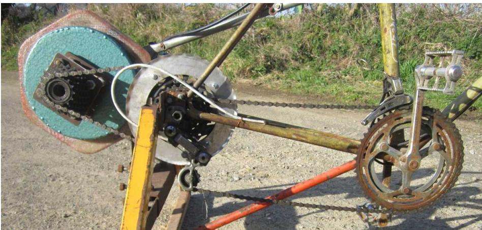
Une cadence de pédalage confortable se situe entre 70 et 100 tours par minute. La génératrice produit sa pleine puissance à partir de 300 tours par minute. Nous avons donc mis en place un système permettant de multiplier la vitesse de rotation.
