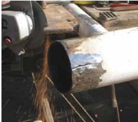
Fig. 62 : Tube pivot de safran cassé
