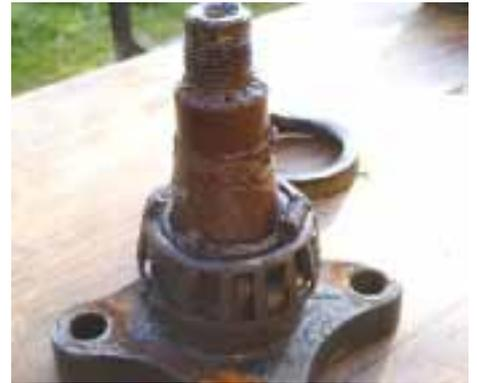
Fig. 60 : Roulement détérioré
