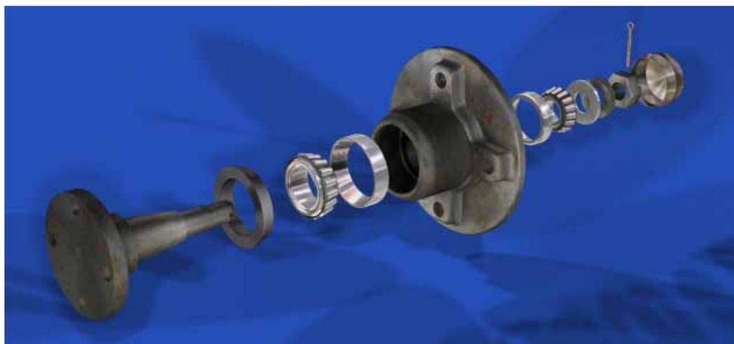
Fig. 38 : Éclaté des deux roulements
