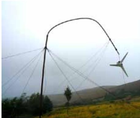
Fig. 59: Rupture des haubans
