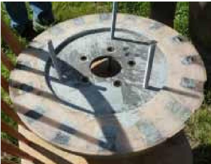
Fig. 32 : Rotor de devant démonté avec vis d'extraction
