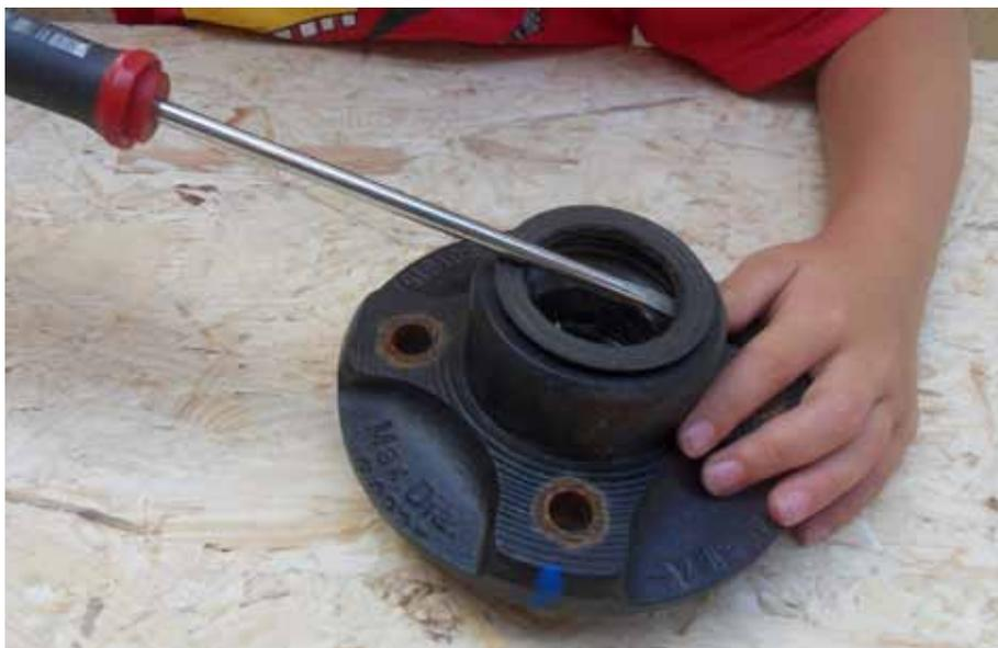
Fig. 39: Démontage du joint spi
