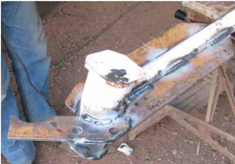
Fig. 45 : Tube de safran renforcé
