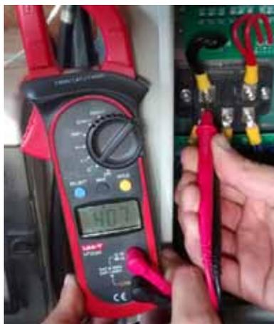
Fig. 56: Test d'un pont de diode
