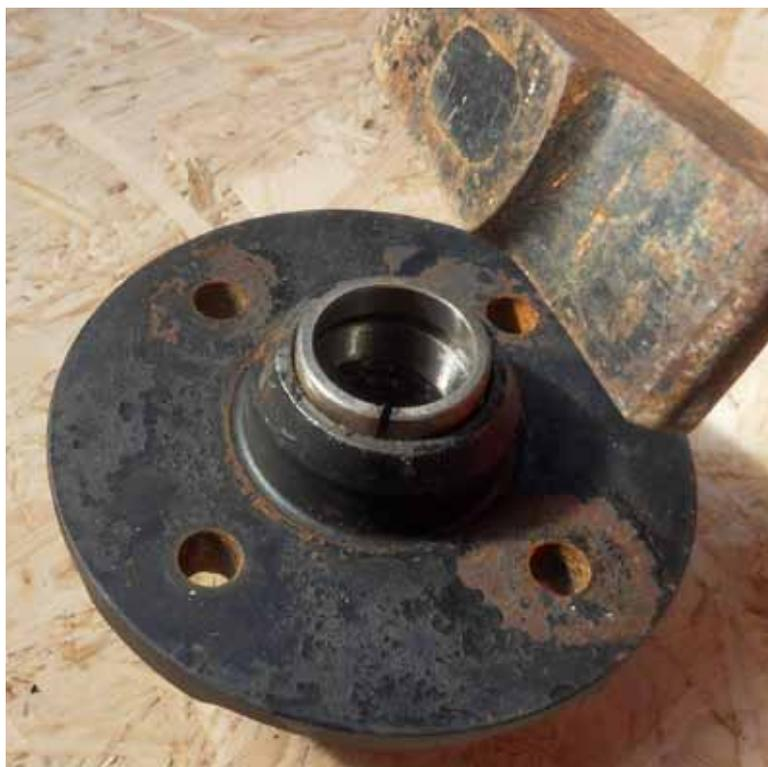
Fig. 42: Mise en place de la nouvelle cage à l'aide de l'ancienne
