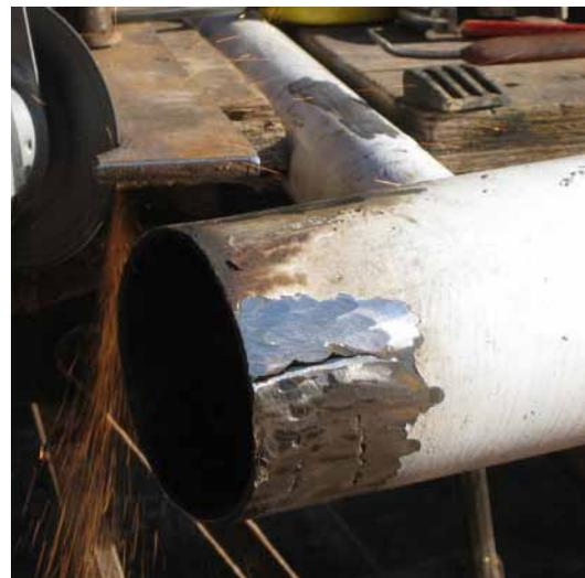
Fig. 46 : Tube du safran fissuré
