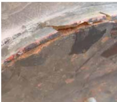
Fig. 35 : Résine fissurée au bord du rotor
