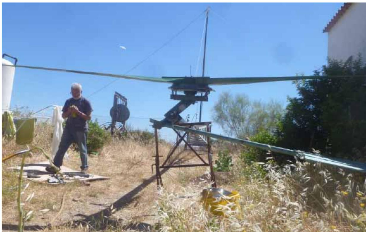
Fig. 16 : Éolienne baissée, en appui
