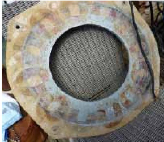
Fig. 33 : Traces de friction sur le stator
