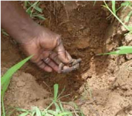
Fig. 61 : Ancrage brisé
