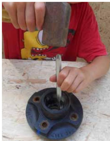
Fig. 40: Démontage cage du roulement
