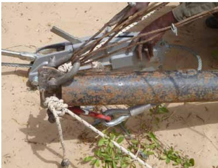
Fig. 11 : Extrémité de la flèche avec le tirefort
