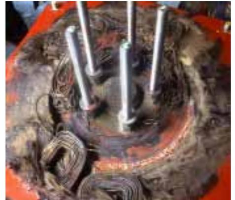
Fig. 63 : Stator brûlé
