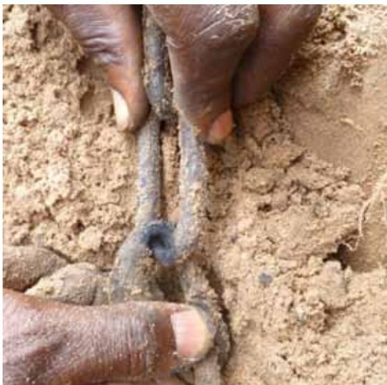
Fig. 50 : Point de faiblesse sur une chaîne
