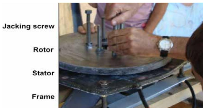
Fig. 28: Desmontaje del alternador
