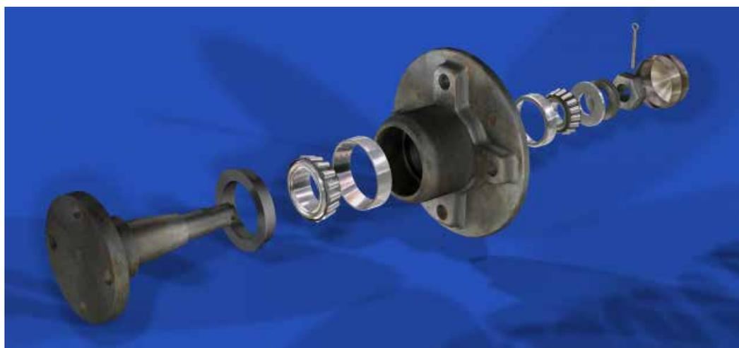
Fig. 36: Despiece completo de un rodamiento
