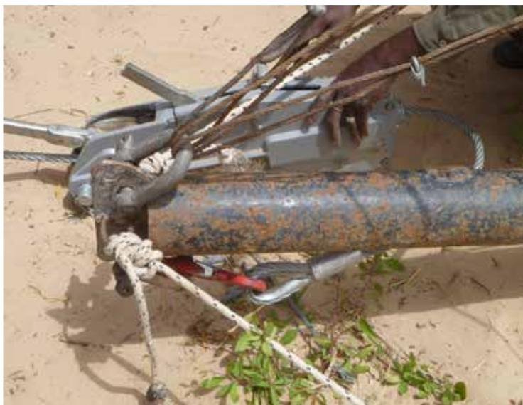
Fig. 11: Parte externa del poste grúa con el polipasto
