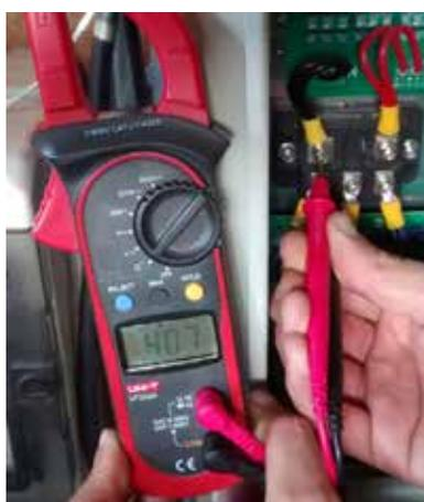
Fig. 54: Prueba de diodo
