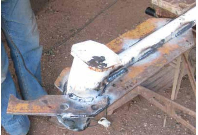
Fig. 42: Bloque de terminales apretado evitando la caída Fig. 43: Veleta de cola reforzada
