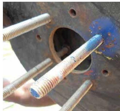
Fig. 29: Marca en la varilla roscada y el agujero
