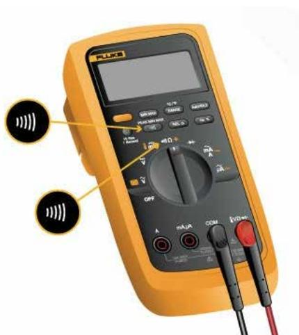
Fig. 53: Multímetro en posición de continuidad
